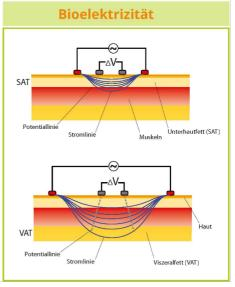
Legende: Geoelektrische- und bioelektrische Impedanzmessungen als "Sondierung" im Vergleich (Ouelle: GGU Gesellschaft für Geophysikalische Untersuchungen mbH)
